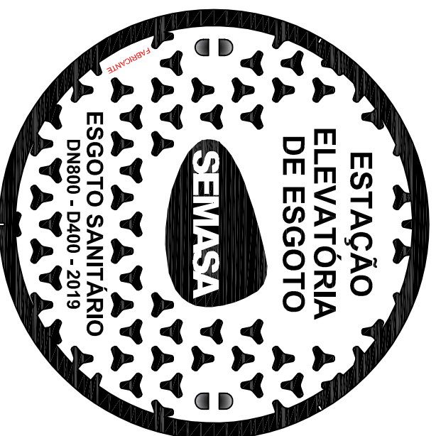
DN 800 - ELEVATÓRIA - D400
