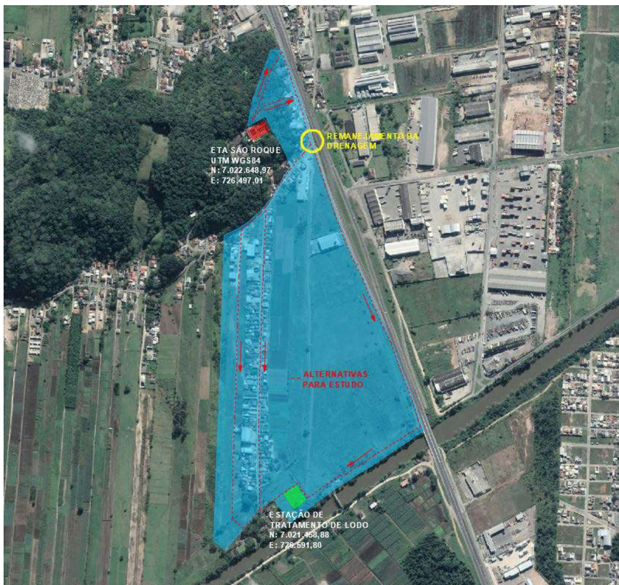
Figura 1 - ETA e ETL - Alternativas para traçado da tubulação e remanejamento da drenagem
